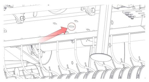
Figure 29. Drain cap
